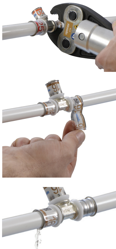
Bild 12: Dreifache Verpresst-Sicherheit eines Verbundrohrfittings: Ablösung der Indikatorfolie nach der Verpressung, deutliches Press-Profil auf der Edelstahl-Presshülse, Wasseraustritt aus der unverpressten Verbindung schon bei geringem Druck.
