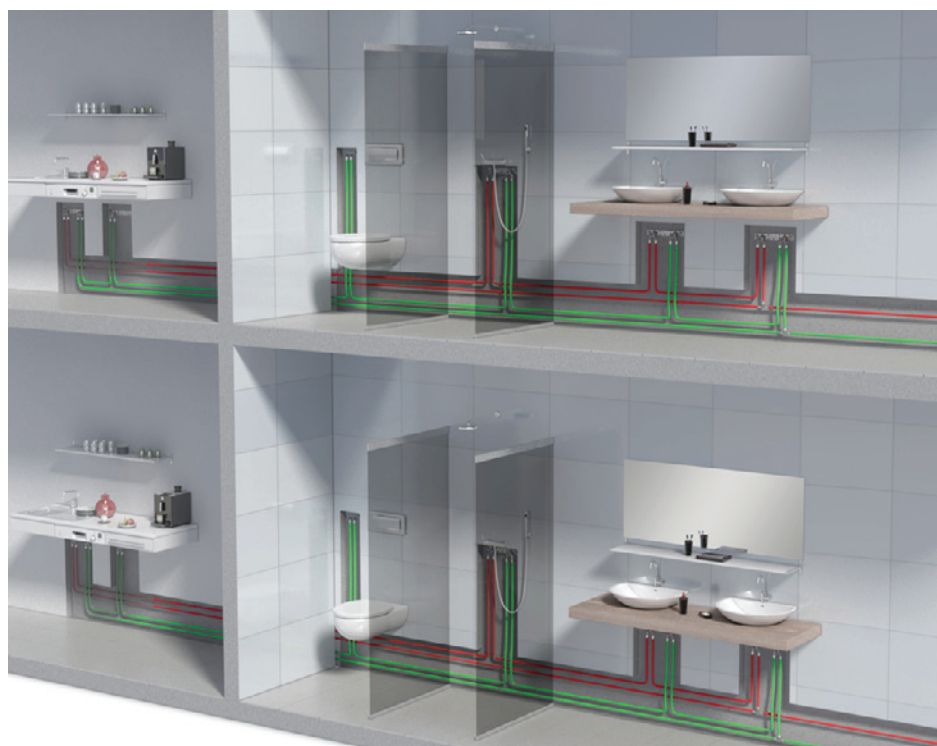
Bild 7: Bei der Durchschleif-Ringinstallation werden die Trinkwasserleitungen am jeweils ersten Verbraucher geteilt und an den weiteren Entnahmestellen mit Hilfe von U-Wandscheiben durchgeschliffen.
