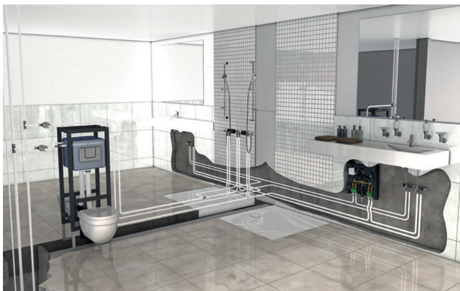
Bild 13: Hygiene-Spülstationen werden in an beliebiger Stelle in die Durchschleif-Ringinstallation der Etage eingebunden und sorgen auch bei Betriebsunterbrechungen automatisch für einen hygienischen Wasseraustausch.
