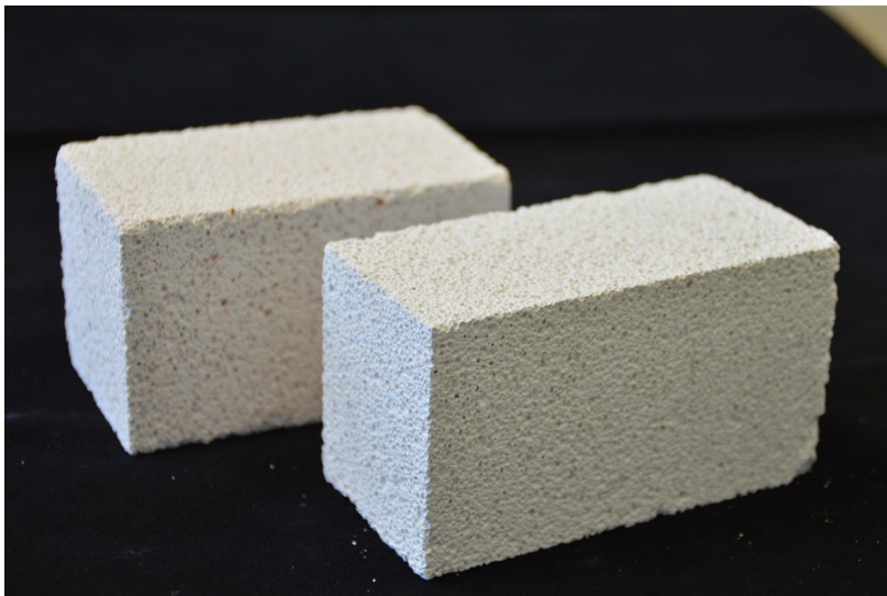
Abbildung 8: Porenbeton aus Ziegel (hinten), Porenbeton aus Kalksandstein (vorne) 205
