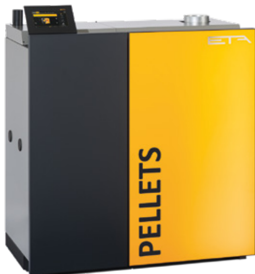
Pelletheizkessel, die alle Anschlüsse für Wärmeleitungen, Pelletzufuhr und Rauchgasrohr oben und seitlich haben, können wandanliegend, platzsparend installiert werden.
