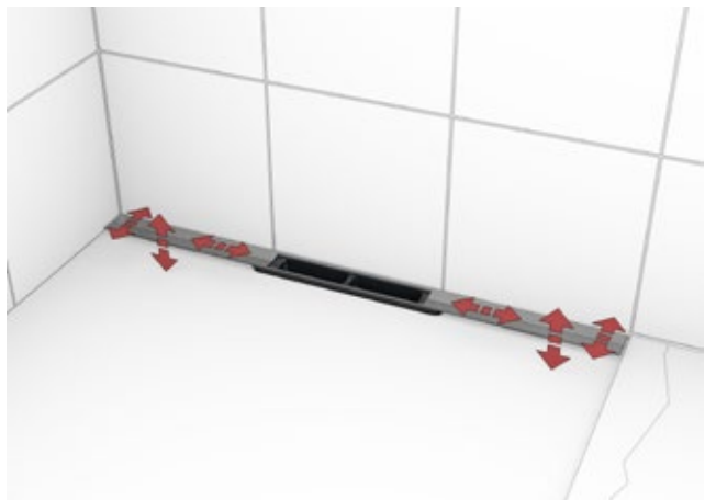
Schritt 6: Auch nach Einbringen des Ablaufs in den Estrich lässt sich das Duschprofil noch in alle horizontalen und vertikalen Richtungen feinjustieren und ist an unterschiedliche Stärken von Wand- und Bodenbelägen anpassbar.
