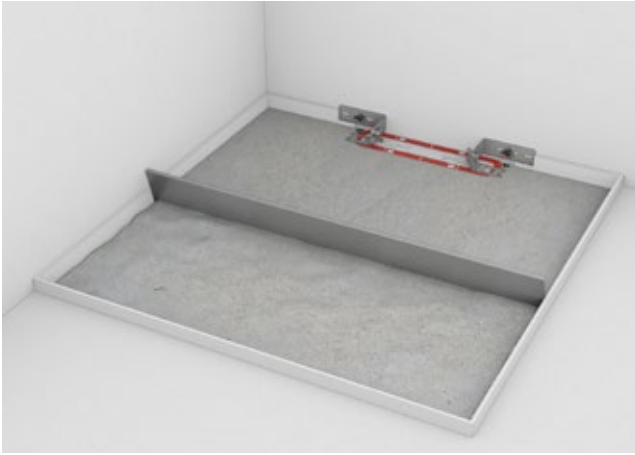
Schritt 3: Der Estrich wird mit 1 bis 2 % Gefälle zur Wand eingebracht. Der werkseitig befestigte Rohbauschutz schützt dabei den Ablauf vor Schäden und Schmutz.
