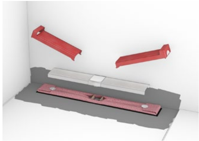
Schritt 5: Nach dem Verfüllen mit Estrich wird der Bauzeitenschutz entfernt und die erste Schicht der Verbundabdichtung aufgetragen.
